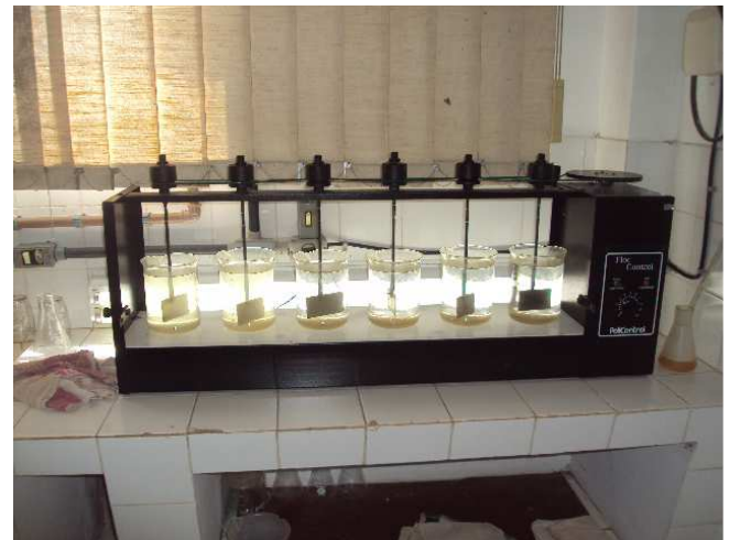
Figura 29 – Laboratório ETA – Jar Test
