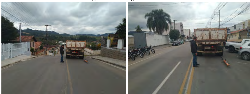
Figura 5 e 6 – Viga Benkelman
