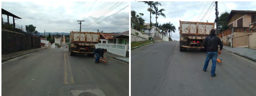
Figura 3 e 4 – Viga Benkelman
