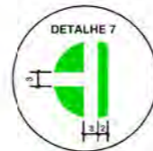
DETALHE DE FIXAÇÃO AO SOLO PARA PLACAS DE REGULAMENTAÇÃO E ADVERTÊNCIA 0,80x0,30x0,30m
